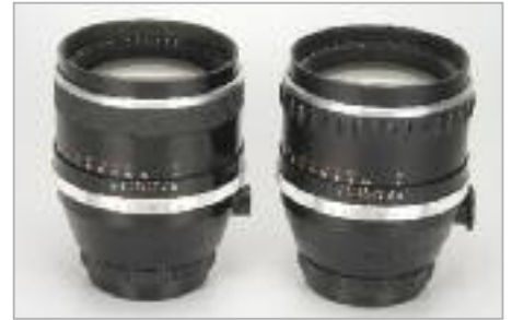
Die frühesten Fertigungslose des Sonnar 2,8/180 verfügen nur über einen schmalen Stativanschluss. Zusammen mit dem breiteren Stativanschluss wurde das Sonnar mit der automatischen Blendenkorrektur ausgestattet. Beide Varianten wurden sowohl mit Belederung als auch mit Rautenring gefertigt.
