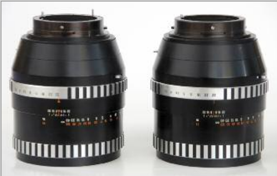
Links ist ein Sonnar 2,8/180 mit dem Stößel zur Blendenwertübertragung der PENTACON super zu sehen, rechts ein Sonnar für PENTACON six. Deutlich ist neben dem Stift für die Springblende beim linken Objektiv der Stößel für die PENTACON super erkennbar.
