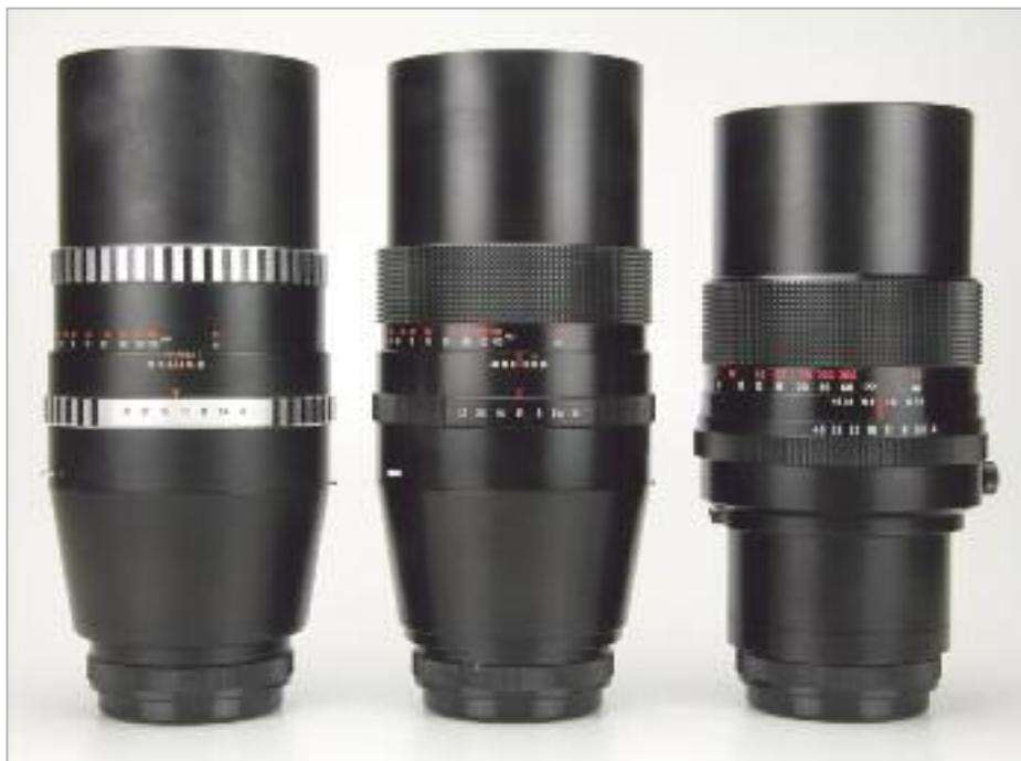
Aufgrund der späten Einführung des Sonnars 4/300 gibt es nur wenige Varianten. Abgebildet sind die drei Hauptvarianten. Dabei hebt sich das 1974 neu gerechnete Sonnar (rechts) deutlich von den anderen ab. Neben den Neuerungen, welche zur gleichen Zeit auch für das Sonnar 2,8/180 eingeführt wurden, erweiterte man die Blendenwerte bis 45. Durch die neue Konstruktionsweise konnte das Objektiv erheblich gekürzt werden. Mit einher ging eine deutliche Gewichtsreduktion.
