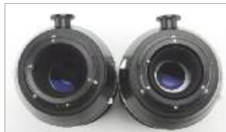
Bei Nahaufnahmen muss ein Verlängerungsfaktor berücksichtigt werden. Bei den Sonnaren 2,8/180 und 4/300 aus dem Zeitraum 1963-75 wird der Verlängerungsfaktor durch automatische Öffnung der Blende kompensiert. Beide Objektiven sind auf Blende 4 eingestellt. Das Objektiv links befindet sich dabei in der Nahfokussgrenze. Die Blendenöffnung hat sich dabei vergrößert.
